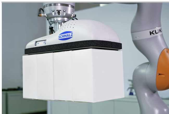
Sistema di presa ad area FXCB per la movimentazione di scatole di cartone
